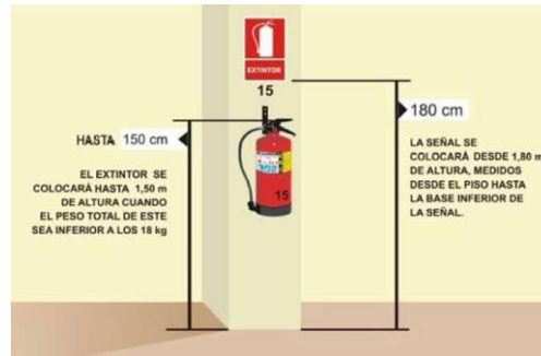
Figura 6: Altura de la instalación de extintor igual o menor a 18 kg.
