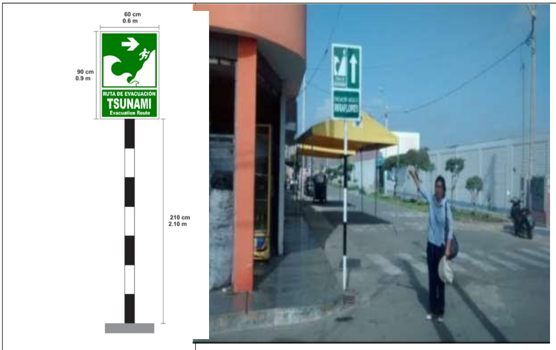
Figura 51: Cartel de ruta de evacuación ante tsunami
