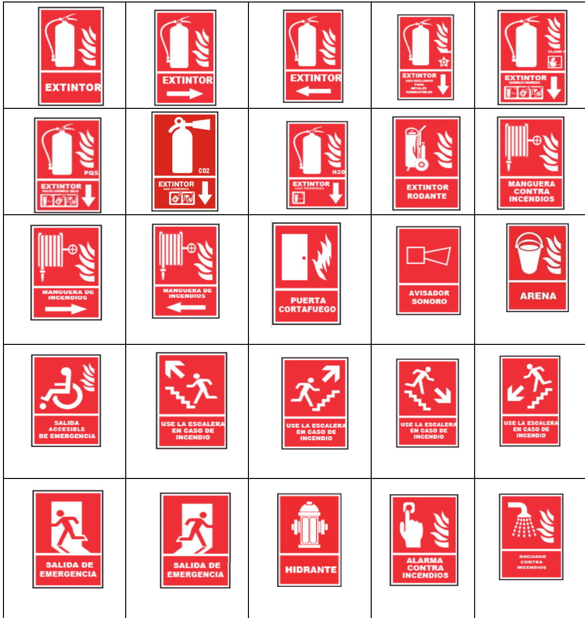
Figura 24: Carteles para equipos contra incendios
