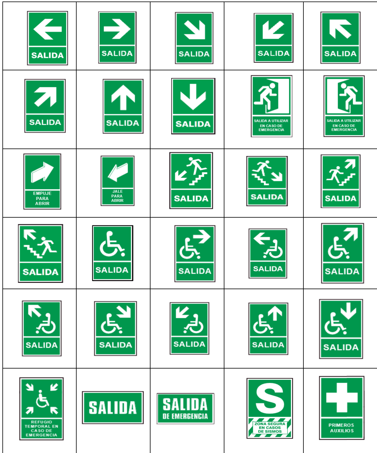
Figura 16: Carteles de evacuación y emergencia
