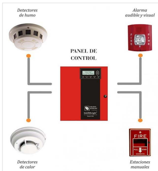
Figura 1: Sistema de detección y alarma de incendios
